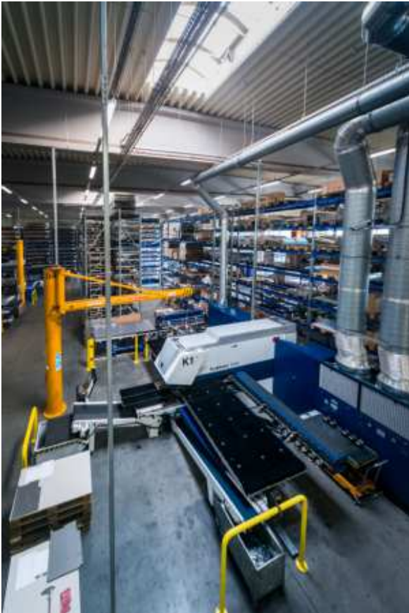
Változatos alkatrészek kombinált lézer-stanz berendezéssel
